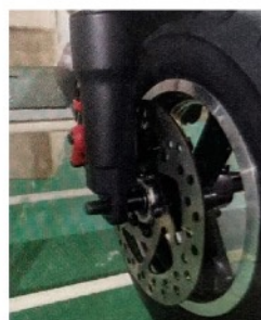
6. Prostrčte hřídel přes druhou stranu vidlice
