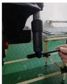
3. Vložte hřídel z pravé strany a nasadte větší těsnění
