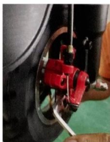
8. Šestihranem upravte brzdové destičky, dokud neuslyšíte téměř žádný zvuk destiček
